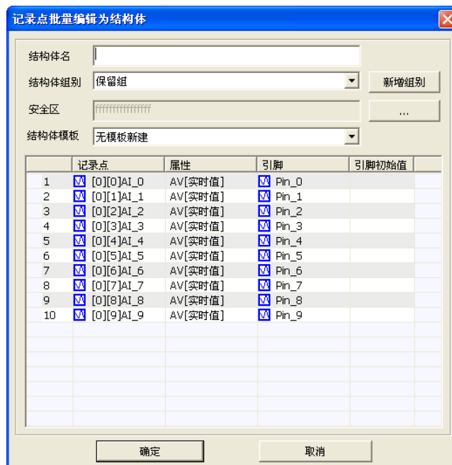
图 5-42 记录点批量编辑为结构体
