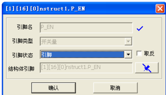
图 5-47 结构体引脚引脚状态
