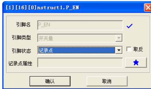
图 5-49 结构体引脚记录点状态
